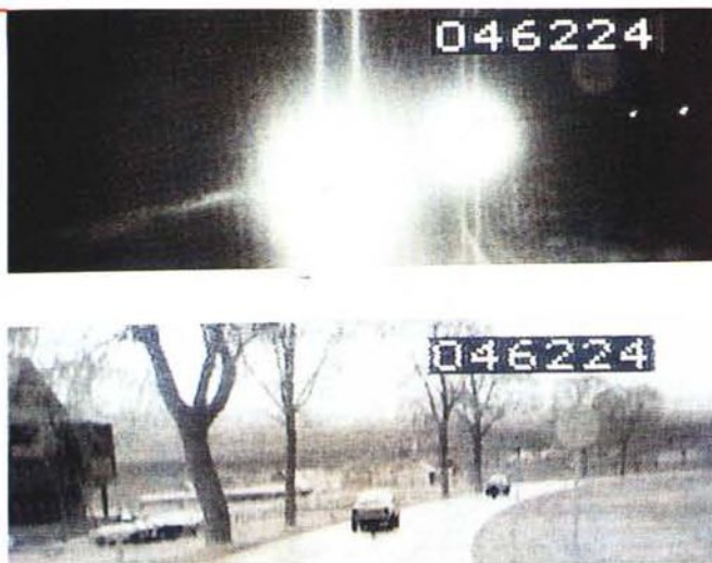
Figura 1-1: Ecco un risultato incoraggiante ottenuto dal piano di ricerca denominato Vision Enhancement. Vediamo ciò che viene percepito comunemente da un guidatore abbagliato da auto che sopraggiungono sull'altra corsia e ciò che vedrebbe invece con l'adozione del sistema «anti abbagliamento». Esso è basato su un pannello a cristalli liquidi incollato al parabrezza anteriore, che si sincronizza automaticamente con i fari anteriori delle auto che sopraggiungono, in modo da annerirsi ad ogni impulso luminoso. Ciò annulla l'effetto di abbagliamento e permette di percepire una immagine nitida, grazie all'effetto di persistenza dell'immagine sulla retina.
